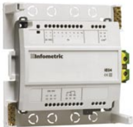
Infometrics mätnod i kapsling (124 x 107 x 45 mm)
